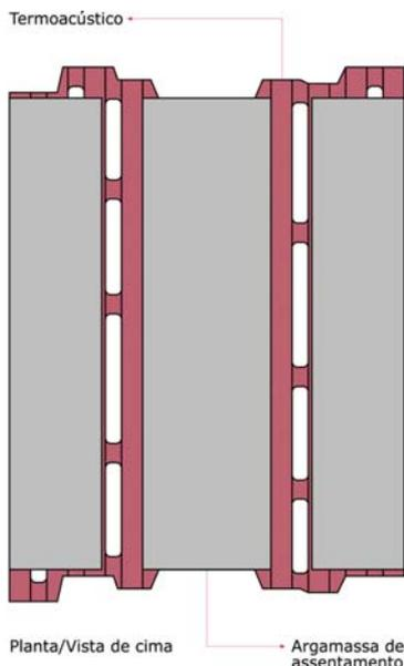
O bloco deverá apresentar-se limpo e livre de gorduras. O assentamento deverá ser realizado contrafiado, com o cuidado de deixar as duas faces da parede regulares. Será assente com argamassa bem apertada nas juntas verticais e horizontais, com espessuras entre 10 a 15 mm, preferencialmente pré-doseada, ou em alternativa com uma argamassa bastarda, com um traço volumétrico aproximado de (1;1/2;8) (cimento; cal hidráulica; areia).
